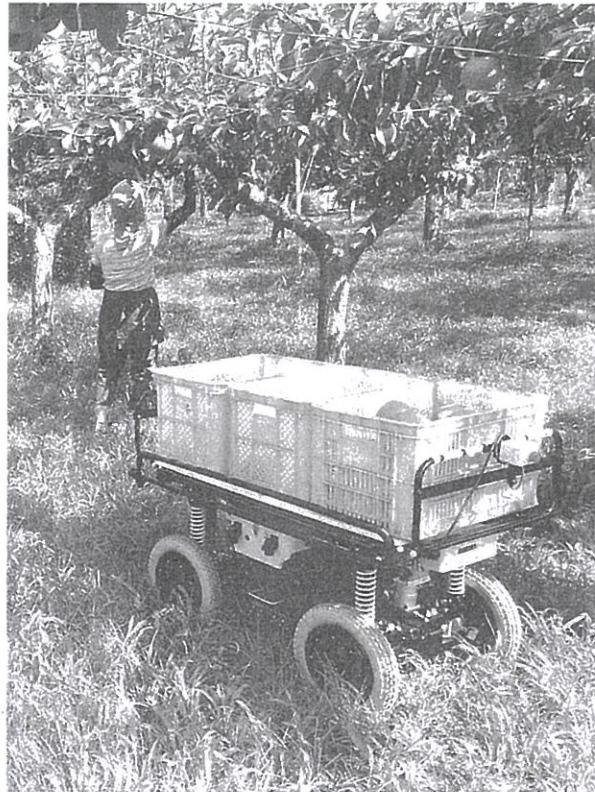
果実の入ったコンテナを載せて、収穫中の農家の背後を自動で付いていく小型ロボット（ドンキー社提供）
